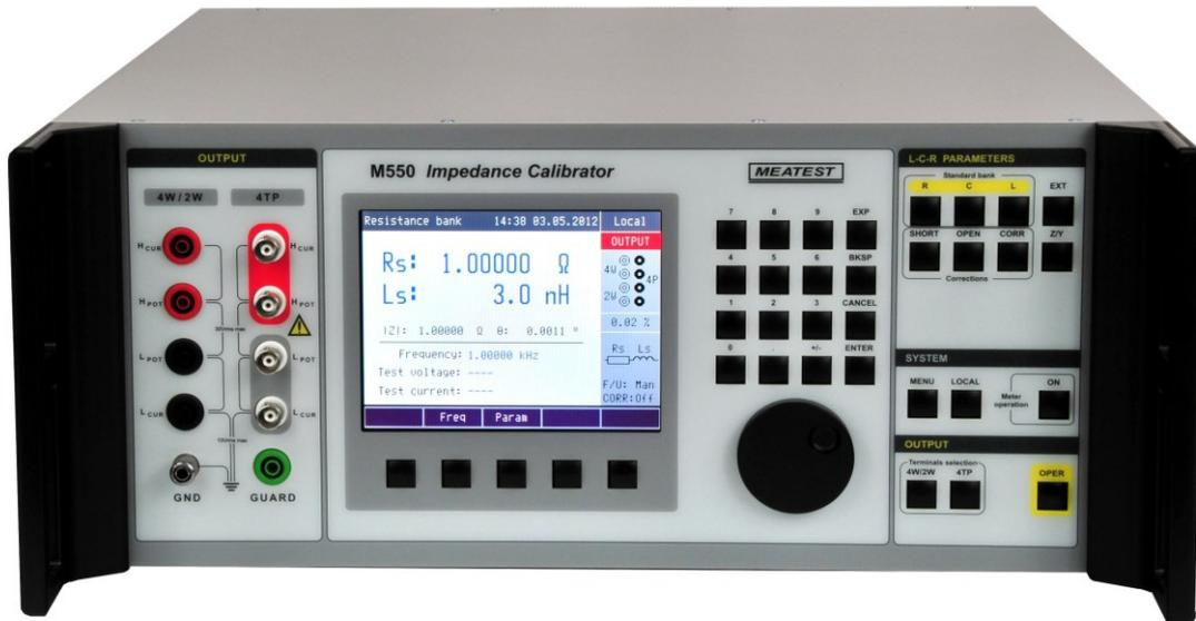
La fréquence de base applicable va de 20 Hz à 1 MHz en mode coaxial et jusque 100 kHz en mode non coaxial. Les mémoires de calibration contiennent aussi bien des valeurs de standards simples que complexes (impédance, conductance). Le mode parallèle ou série peut être sélectionné. Le calibrateur est équipé de connexions de références OPEN et SHORT pour éliminer l'influence des câbles.
