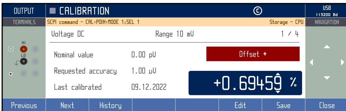
Obr. 29 Přímá kalibrace daného bodu
