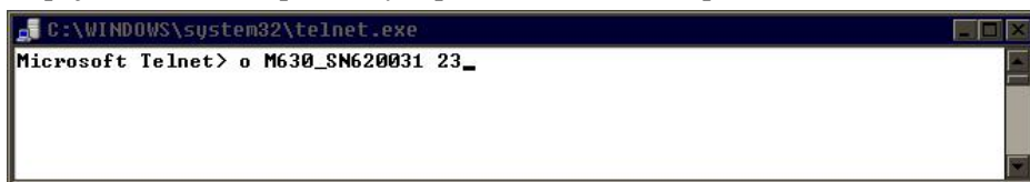
Obrázek 23 Připojení přes LAN 1
